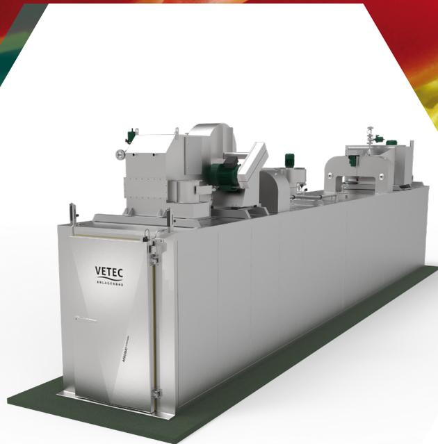
Der **AEROMAT COMPOUND** ist eine Heißräucher- und Kochanlage mit automatischem Transport in einen nachgeschalteten AEROMAT COOL. Die perfekte Anlage für das Rösten, Trocknen, Warm- und Heißräuchern, Brühen, Kochen und Heißluftgaren im Heißräucher- und Kochbereich. Anschließend erfolgt das Herunterkühlen der Lebensmittel mit Duschwasser und Luft im Intensivkühlbereich.
